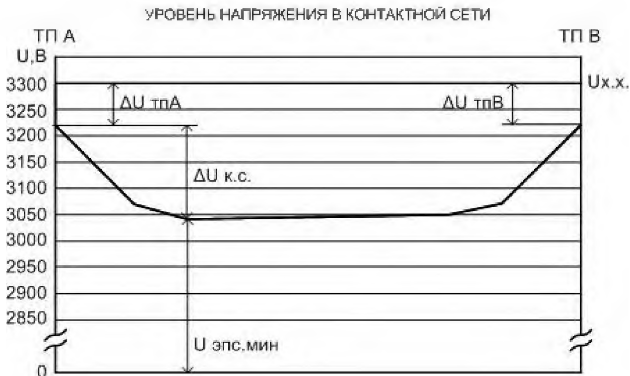
Рис. 4. Пример построения графика уровня напряжения в контактной сети.
