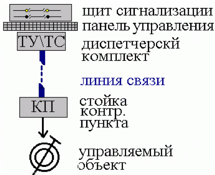
Рисунок 1. Обобщающая схема работы системы телемеханики
