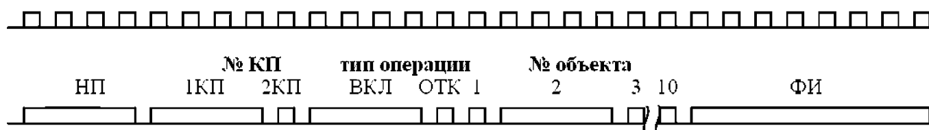
Рисунок 2. Кодирование приказа на импульсах в системе ТУ
