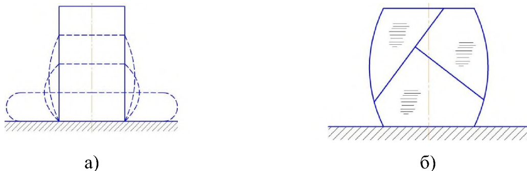
Рисунок 2.13 - Вид образцов после сжатия: а) из малоуглеродистой стали; б) из хрупкого материала (разрушение)
