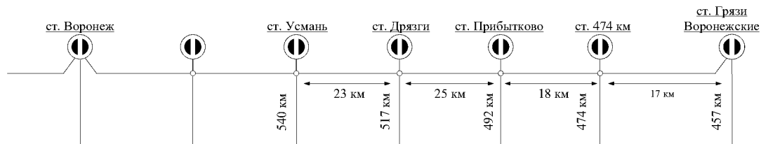
Рисунок 2.5 – Схема соединения пунктов «последовательной линейной цепью»
